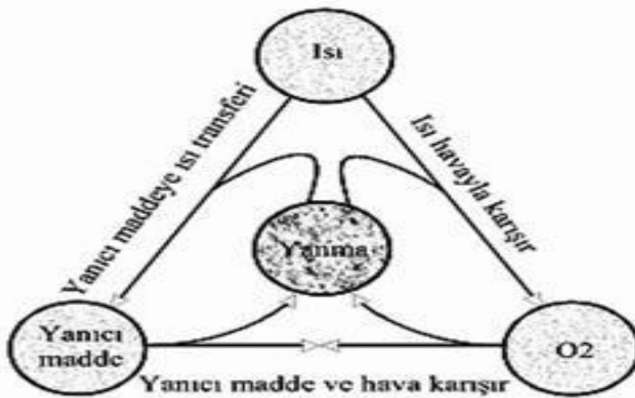
Şekil 7: Yangın Üçgeni (Özlem & Mayuk, 2013; Tama, 2012)
